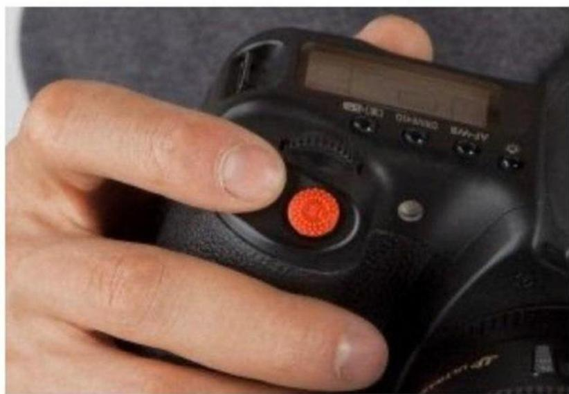
امکان ندارد برای هر بار عکاسی ، سرو کارتان به این دکمه معروف نیوفتد. قطعا پرکاربردترین دکمه تعییه شده روی بدنه دکمه شاتر است. شاتر همان دکمه ای است که با فشردن آن عکس ثبت می شود. یک نکته ظریف در مورد دکمه شاتر وجود دارد که برخی افراد ممکن است از آن بی اطلاع باشند؛ دکمه شاتر دکمه ای دو وضعیتی است یعنی ابتدا تا نیمه فشرده می شود، (اصطلاحا به آن نیم شات می گویند) سپس تا انتهای فشرده می شود و فرآیند
