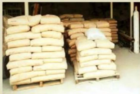
تصویر شماره ۱۹.۱۲. نحوه انبار کردن سیمان
