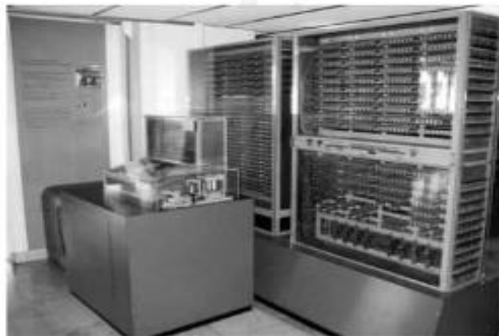
تصویر ۳-۴ رایانه Z۳ ساخته کنراد تسوزه: اولین رایانه الکترومکانیکی کاملاً خودکار
